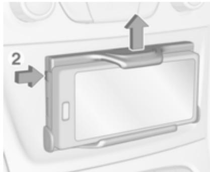
2. Drücken Sie auf die Taste (2) links oben, um den Schieber für die Höhenverstellung zu lösen.
