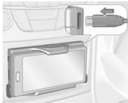
Verbinden Sie das Smartphone mit Hilfe des passenden Verbindungskabels mit dem Telefonhalter. Verschiedene Versionen von Verbindungskabeln sind als Zubehör erhältlich.
